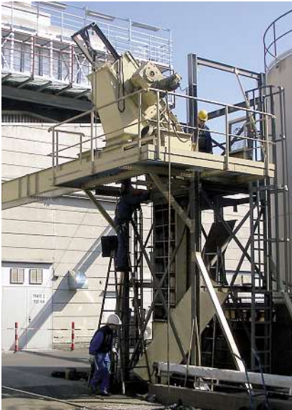
▲ Spezialförderer für beengte Platzverhältnisse: Ölsaaten-Annahme unter einer Lkw-Entladegasse
