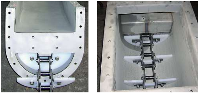
▲ Trogkettenförderern sind auch für den Transport von Flüssigkeiten (Öl) geeignet; Steigungen von 20 - 30° sind möglich.
