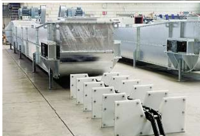
◀ ▲ Trogkettenförderer für große Förderleistungen mit Produktrückführung im Antriebskopf
