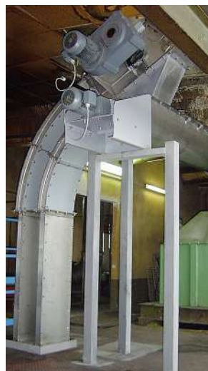
▲ Übergabestation von vertikalem TKF zu einem horizontalen Schneckenförderer
