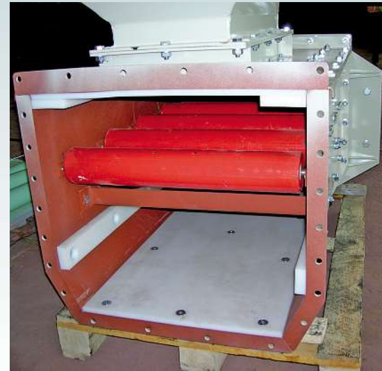
▲ Geschlossener, selbstreinigender Schöpfgurtförderer für Dämmstoffe – Umlenkopf mit Zulauftrichter in der Fertigung
