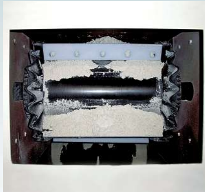
▲ Materialabwurf eines geschlossenen, selbst-reinigenden Schöpfgurtförderers für Gips
